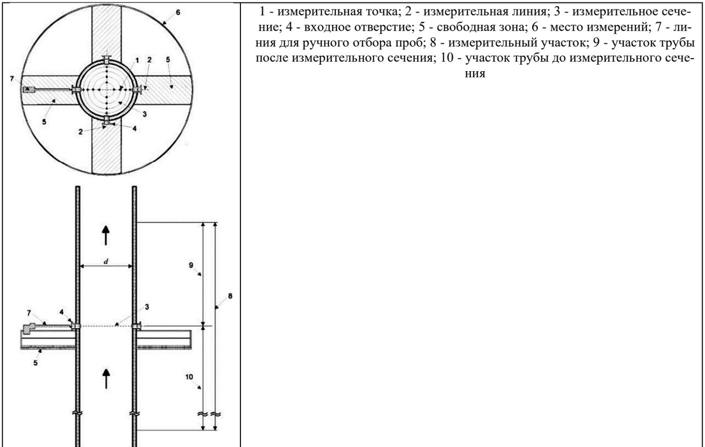
1 - измерительная точка; 2 - измерительная линия; 3 - измерительное сечение; 4 - входное отверстие; 5 - свободная зона; 6 - место измерений; 7 - линия для ручного отбора проб; 8 - измерительный участок; 9 - участок трубы после измерительного сечения; 10 - участок трубы до измерительного сечения
