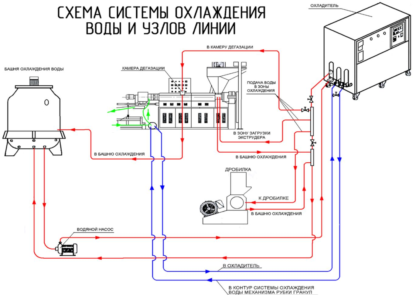
Рисунок 1.6 - Схема системы охлаждения воды и узлов комплекса оборудования охлаждения оборотной воды для технологического процесса
